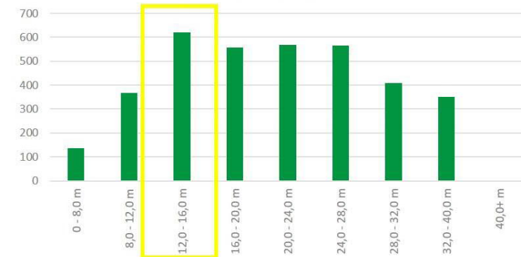
Aantal viaducten met gemiddelde overspanningslengte (Datafile DISK)
