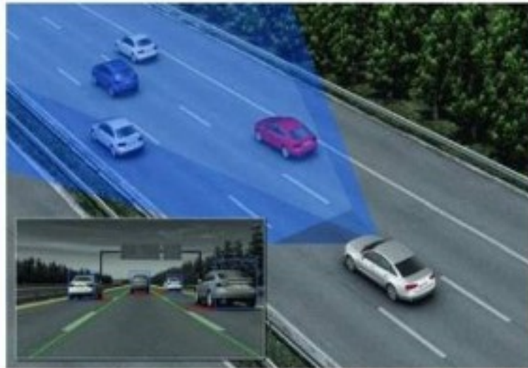
Het Lane Assist-systeem is niet optimaal te gebruiken door slechte belijning en te veel bermgroen. Foto: Royal Haskoning DHV
